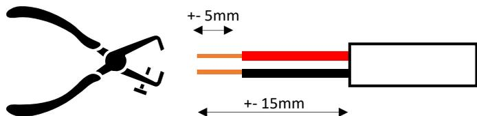
**NL -** 1. Verwijder enkele centimeters van de mantel (het omhulsel) van het belsnoer met behulp van een striptang. Strip ook beide aders in het snoer enkele millimeters.
